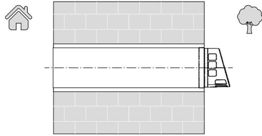
Не перекривайте повітрязбірні решітки та отвір зливу конденсату. За необхідності забезпечте герметичність та нерухомість повітропроводу в отворі за допомогою монтажних клинів (поз. 3) з комплекту постачання та монтажної піни.
